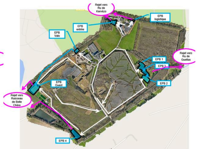
Figure 11 : Schéma des eaux pluviales
